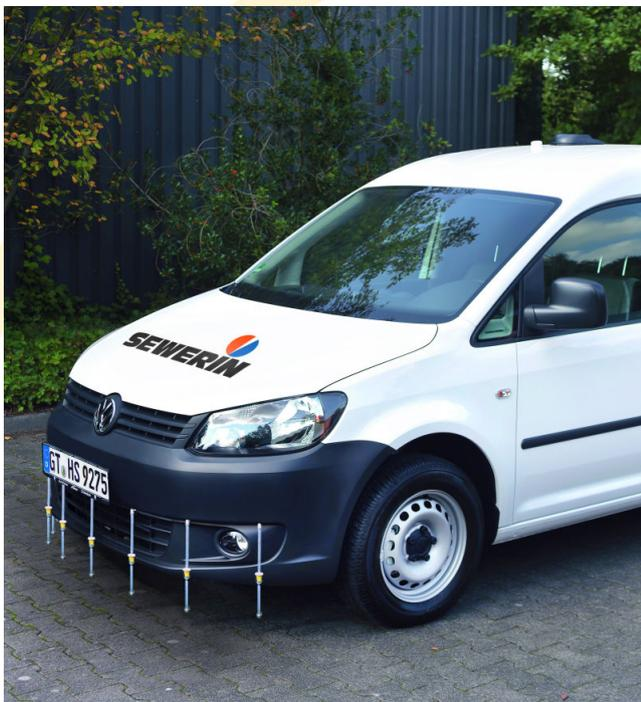
Accanto al sistema Leakplotter FID a ionizzazione di fiamma, apprezzato in tutto il mondo per la sua precisione e robustezza, la Sewerin ha introdotto il suo nuovo sistema con tecnologia laser per la ricerca fughe gas su reti interrate mediante automezzo.
