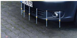
aspirazione campione gas mediante sonde a campana o sonde a filo montate sull'automezzo
